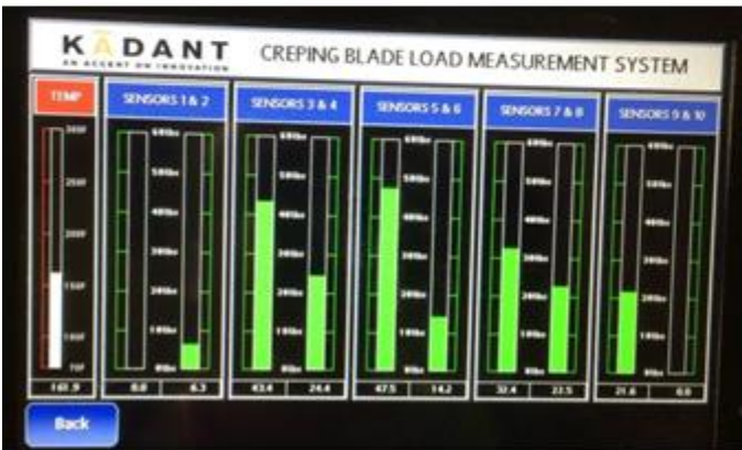
Pantalla de supervisión de carga
