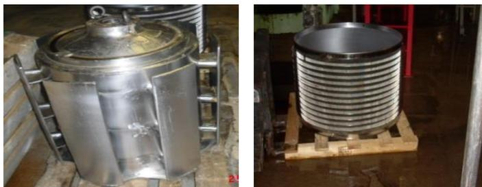
**Despues – Rotor Eclipse R + Canasta C-Bar HerculeX // 0,25mm**
